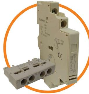
Блоки контактов серии EGV2-AE (AN) монтируются на боковые стороны автоматического выключателя защиты двигателя серии EGV2. Они используются для дистанционной сигнализации состояния контактной группы автоматического выключателя, включения резервного питания или контрольной цепи и т.п. Блоки контактов имеют два исполнения фронтального и бокового монтажа .
