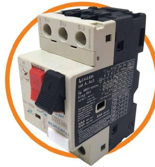
Автоматы защиты двигателя используются для комплексной защиты электродвигателей от токов короткого замыкания, перегрузки и дисбаланса фаз. Они выполняют функции автоматического выключателя и теплового реле, этим позволяют сэкономить место в щите.
