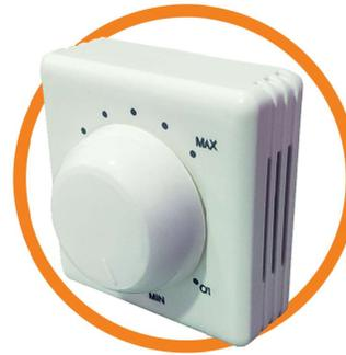
Работа регулятора основана на изменении выходного напряжения с помощью симистора. Регулятор осуществляет регулирование скорости вентилятора в соответствии с положением регулировочной ручки на лицевой панели. Регулятор оснащен встроенным выключателем и регулятором минимальных оборотов двигателя. Регулятор позволяет изменять выходное напряжение от 100 В до 220 В.
