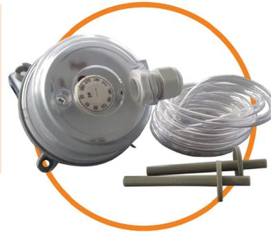
Измерение давления осуществляется путем измерения перепада давления на мембране датчика. Заданное значение устанавливается с помощью ручки под крышкой корпуса. Изменение давления влияет на мембрану, которая связана с переключающим контактом. Изменения положения мембраны переключает реле в случае отклонения давления от заданной величины.
