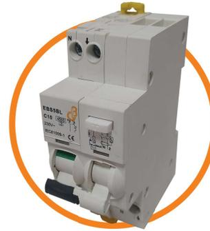
Обеспечивает:– защиту человека от поражения электрическим током при случайном непреднамеренном прикосновении к токоведущим частям электроустановок при повреждении изоляции; предотвращает пожары вследствие протекания токов утечки на землю; защищает от перегрузки и короткого замыкания. Сохраняет работоспособность при пониженном напряжении сети (до 50 В), обладает высокой механической износостойкостью. Предусмотрена индикация срабатывания от дифференциального тока.
