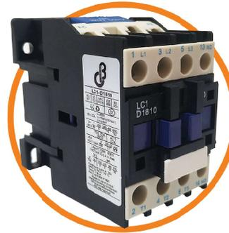
Силовой контактор серии LC1 - электромагнитный, электрический аппарат, предназначенный для частых включений и выключений (до 3 600 переключений в час) электрических силовых цепей переменного тока. Широко применяется для дистанционного управления электрическими машинами и аппаратами в установках переменного тока напряжением до 690 В и силе тока до 80 А.
