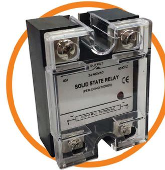
Твердотельное реле MGR – это современное полупроводниковое устройство, которое предназначено для бесконтактной коммутации силовых цепей исполнительных механизмов, преимущественно нагревательных элементов (ТЭН), осветительных приборов и маломощных электродвигателей и других устройств с рабочим напряжением до 480 В переменного тока. В зависимости от исполнения, их работой можно управлять или постоянным 3-32 В, или переменным 70-280 В током
