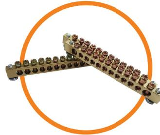
Шина нулевая PP – 4/6 – 12/2 предназначена для электрического и механического соединения нулевых защитных и фазных проводников. Она имеет два отверстия для крепления расположенных по краям шин. Для обеспечения качественного соединения, а также упрощения дальнейшего обслуживания, шина выполнена единым токопроводящим элементом. Её монтаж прост и не занимает много времени.
