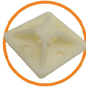
Площадку для стяжек применяют для монтажа проводки и прокладке кабельных сетей. Для крепления хомутов на гладких поверхностях. С самоклеящимся слоем. Площадка под стяжку с двух сторон по одному отверстию для возможности дополнительной фиксации к поверхности с помощью саморезов или гвоздей.
